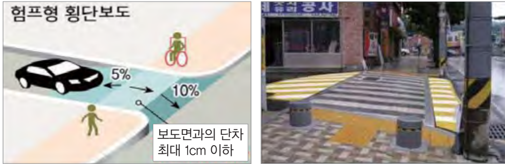
〈그림 2.5〉 험프형 횡단보도 설치 요령
