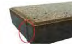
콘크리트 블록의 돌기
